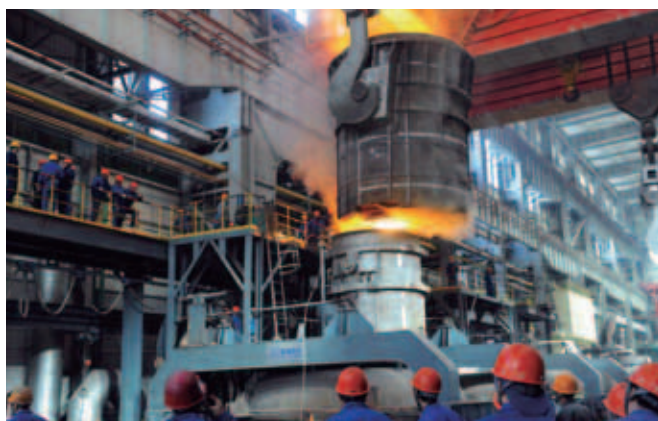
中信重工安裝了除塵設備的VC大型鋼錠真空澆注設備
