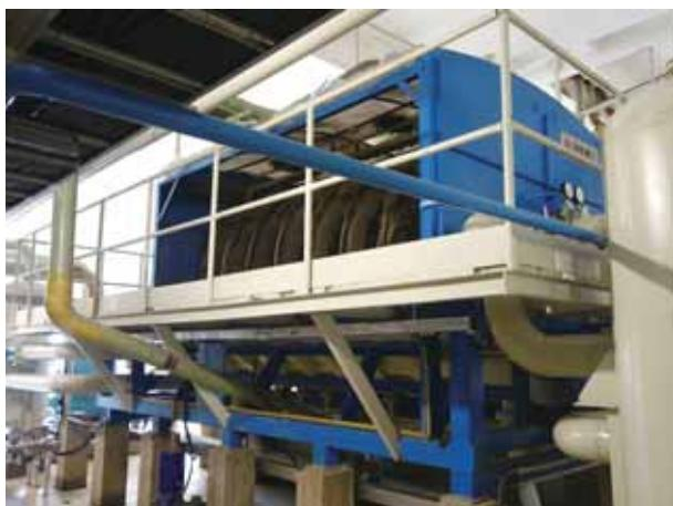
中信重工開發的GDYT系列電廠脫硫石膏脫水專用過濾機
